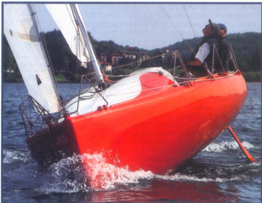
Le linee d'acqua del Naus seguono una distribuzione dei volumi che tende a restare costante da prua (foto a lato) a poppa. Balza subito all'occhio l'enorme baglio massimo (tre metri) su una lunghezza fuori tutto di 6,5 m.
